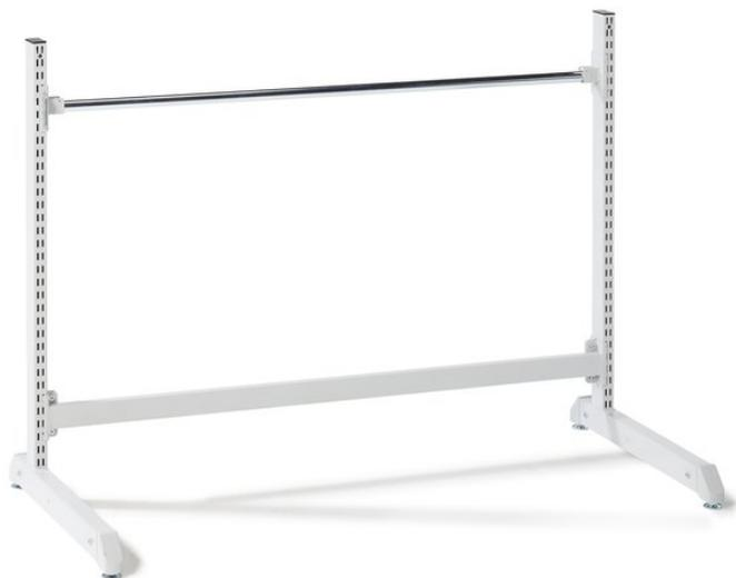
Низкая стойка для рулона. Регулировка положения рулонов по высоте. Диаметр оси: 25 мм. Макс. Ø рулона 800 мм. Может быть оснащена дополнительно комплектом держателя рулонов, комплектом колес и резаком. Макс. нагрузка 40 кг на ось.
