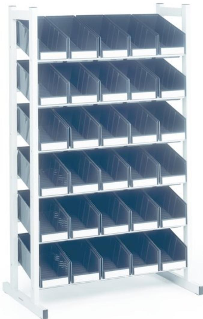
На стойке BR навесные штабелируемые ячейки располагаются под углом 20 градусов, что позволяет легко доставать компоненты из ячеек. Эффективная система хранения при ежедневном использовании. Стойка выполнена из стали с нанесенным эпоксидно - порошковым покрытием серого цвета
