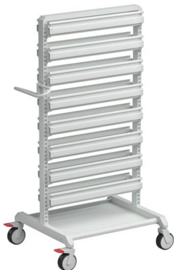
Передвижная стойка в ESD-исполнении для хранения чувствительных к электростатическому разряду компонентов в навесных ячейках(ячейки заказываются отдельно). Стойка имеет по 8 кронштейнов для размещения ESD-ячеек с двух сторон, 4 поворотных ESD-колеса (Ø 100 мм), два из них с тормозами. Нижняя стальная полка в базовой комплектации. Регулируемая по высоте эргономичная ручка позволяет легко перемещать тележку.
